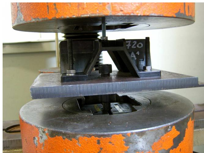
Dispositivo di afferraggio inferiore per la prova di trazione
