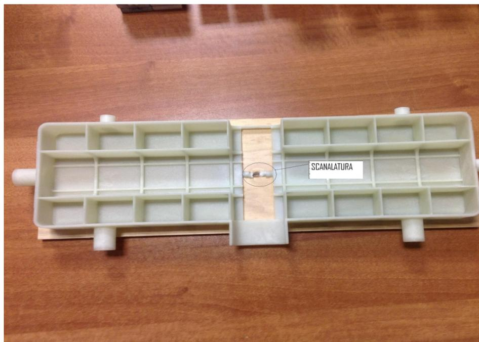
La scanalatura indicata in foto viene riempita dal materiale plastico durante la fase di stampaggio ad iniezione garantendo la massima tenuta e il perfetto accoppiamento dei due materiali (accoppiamento meccanico e non chimico).
